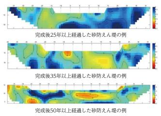
図-3 改良型弾性波探査によるマスコンクリートの健全度評価 (第5回インフラメンテナンス大賞優秀賞受賞) 砂防えん堤の劣化が進んだ箇所を視覚的に表現している
